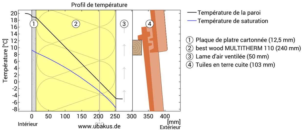
Course de la température et du point de rosée dans la composition. Le point de rosée indique la température à laquelle la vapeur d'eau condensera. Si la température de la composition est au-dessus de température de condensation il n'apparaît pas d'eau liquide. Si les deux courbes viennent à se toucher, il se forme en ce point de la condensation.
